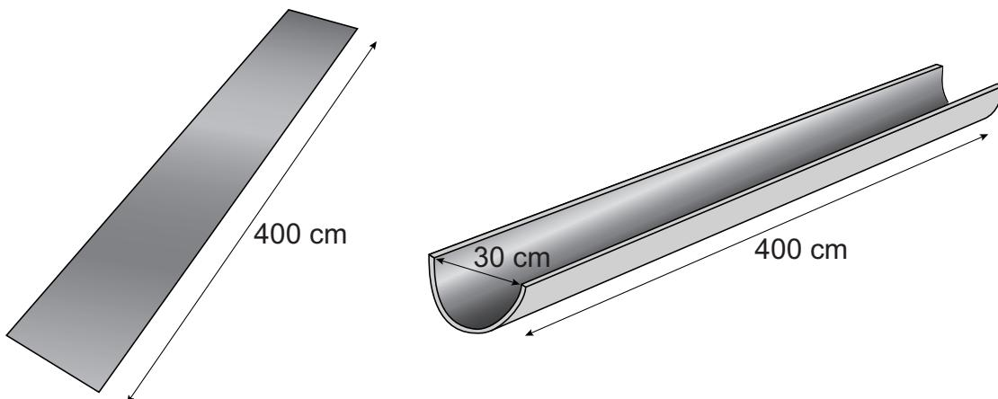
De lengte van de mastgoot is 400 cm. De diameter van de mastgoot is 30 cm. De volgende twee vragen gaan over dit model.
