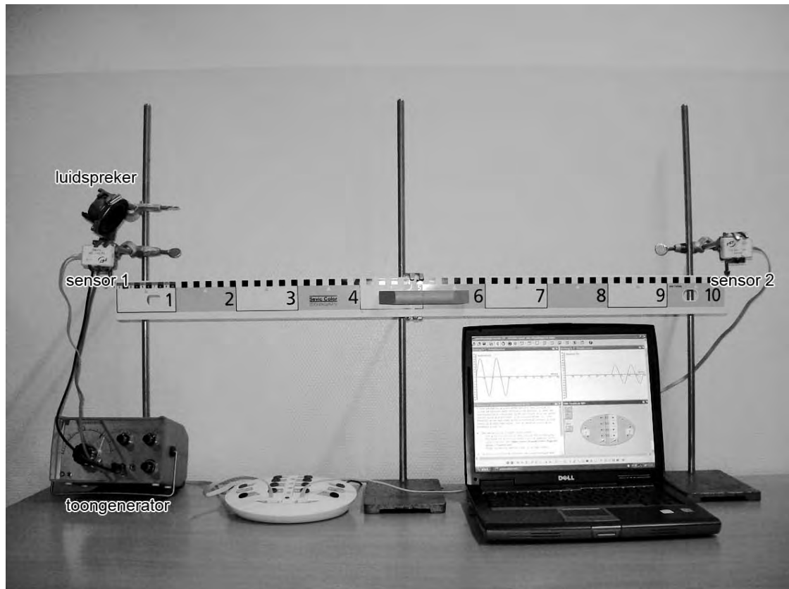
een opstelling voor het bepalen van de geluidssnelheid
